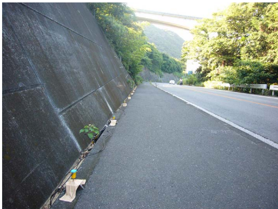
図 8a 大阪府泉佐野市土丸地区における受振器設置状況
