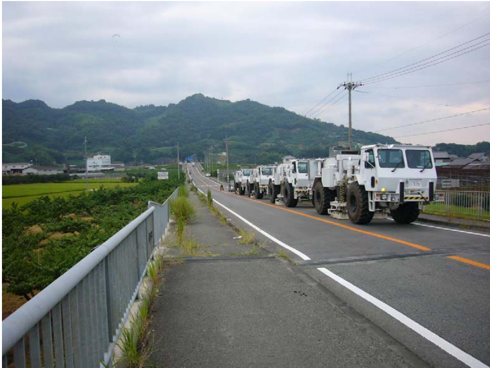
図 8b 和歌山県紀の川市打田町窪地区におけるバイブレータ 4 台による発震状況
